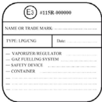
Gornja pločica sa homologacijskom oznakom i određenim tehničkim podacima u sustavu za naknadnu ugradnju mora biti trajno pričvršćena na karoseriji vozila.
