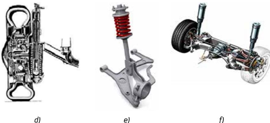
Slika 81: Primjeri vođenja kotača kod neovisnog ovjesa
