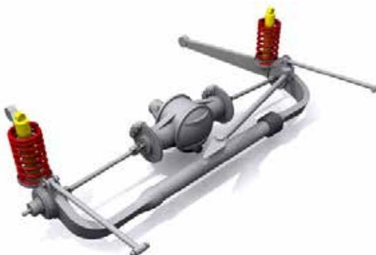
Slika 80: Stražnji poluzavisni ovjes De Dion izvedbe sa podužnim vođenjem kotača
