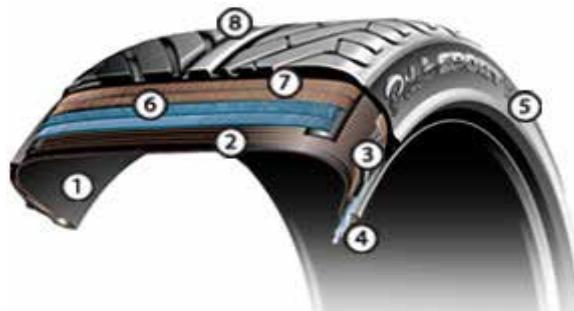
Slika 62: Presjek pneumatika
