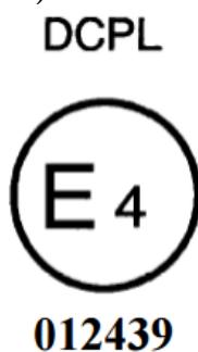
**DC** - Glavno svjetlo svjetlosnim izvorima sa pražnjenjem u plinu ( XENON svjetlo ) – **D**, za oboreno (kratko) svjetlo (**C**)
