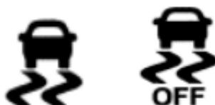
Slika 2: Vozila koja udovoljavaju pravilniku a opremljena su ESC sustavom , moraju biti opremljena svjetlosnim simbolima kao na slikama kada je sustav izvan funkcije
